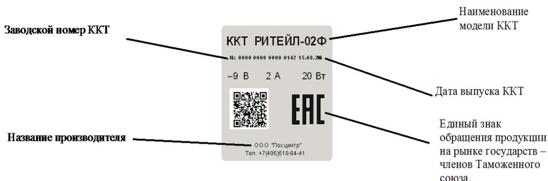
Корпус ККТ обеспечивает возможность опломбирования ККТ как в условиях предприятия-изготовителя, так и в процессе эксплуатации в условиях АСЦ. Место пломбирования – по ГОСТ 18680-73. Пломбировка должна находиться на нижней части корпуса ККТ, сзади на правом или левом винте, удерживающем верхнюю часть корпуса. Новые ККТ, прошедшие приемку на заводе-изготовителе, пломбируются. Оттиск пломбира завода-изготовителя имеет следующий вид:
